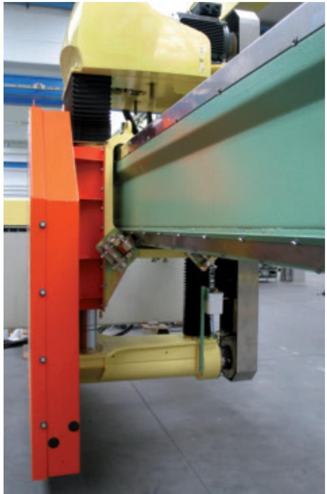
**Il ponte scorre lungo due vie di corsa fissate sui muri di fondazione. Il movimento trasversale del ponte è comandato da due sistemi pignone/cremaglieria, sincronizzati da un albero di collegamento azionato da moto riduttore controllato da encoder e con velocità regolata da inverter.**
