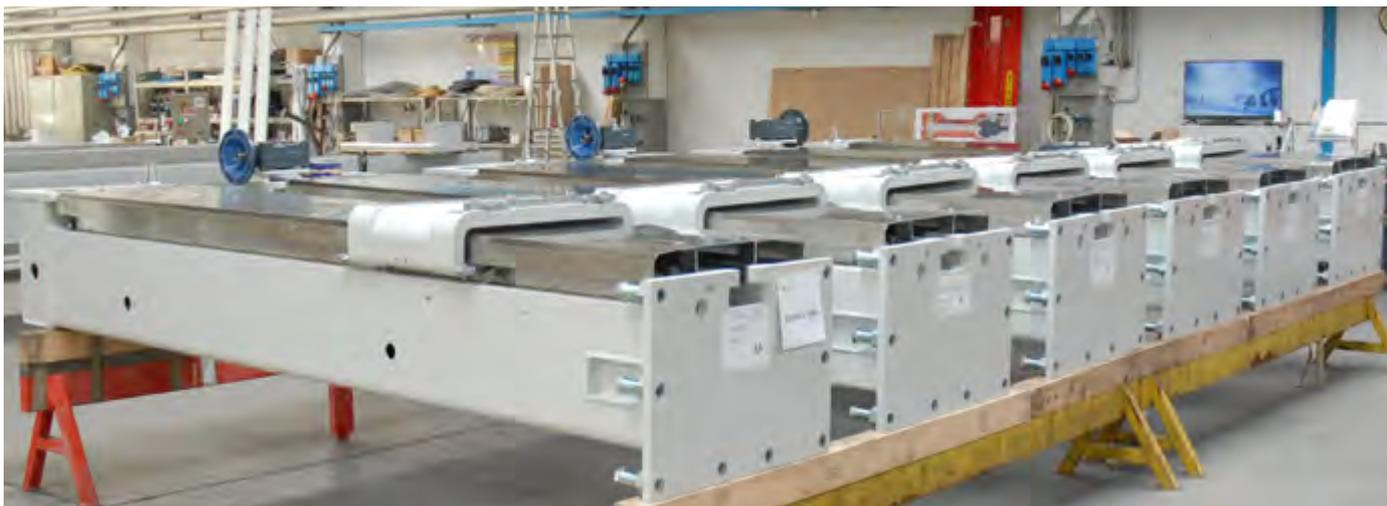
Il carrello portablocchi ribassato e motorizzato si muove su due binari con 4 ruote in acciaio temprato.
