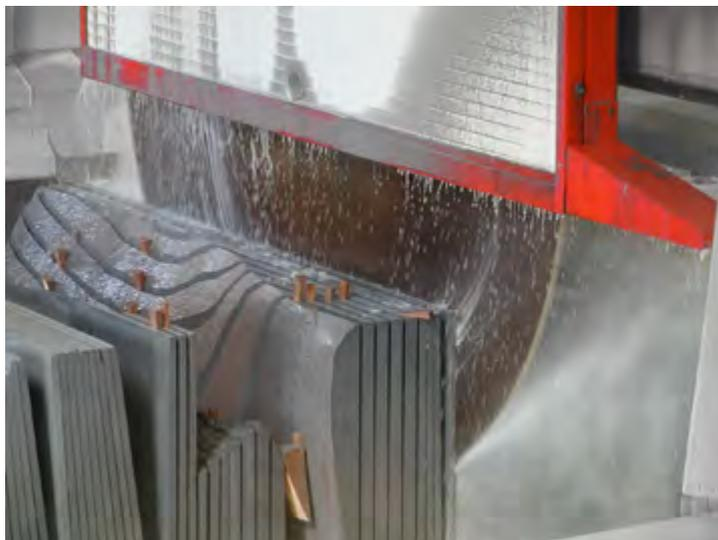
Le macchine **GENESIS GS141** e **GS142**, definite anche **disconi**, sono studiate per il taglio di blocchi di pietra naturale tramite un singolo disco diamantato di grande diametro.
