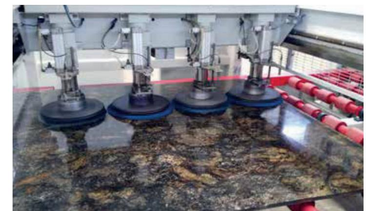
La ceratrice M242 è composta da una robusta struttura a ponte che supporta la trave mobile che alloggia i mandrini che azionano le spazzole rotanti.
